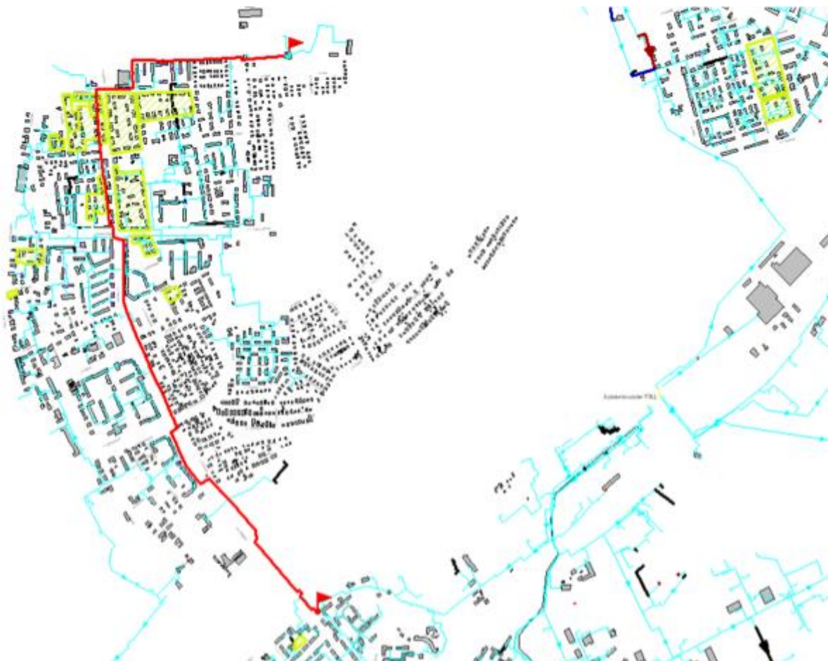
Рисунок 3.1 – Путь для расчёта вероятности безотказной работы тепловых сетей от ТК-45 до С-28п-16
