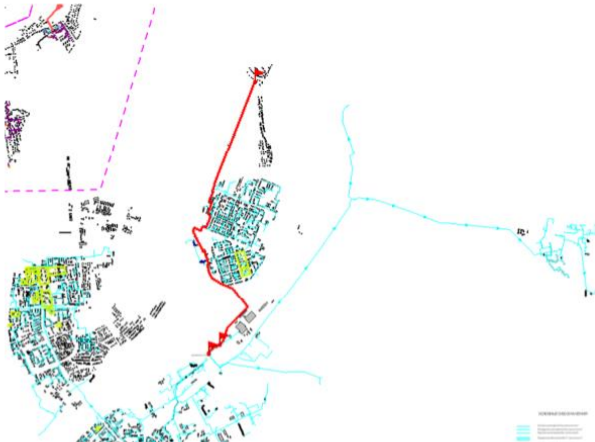
Рисунок 3.8 – Путь для расчёта вероятности безотказной работы тепловых сетей от Архангельской ТЭЦ до потребителя ИП Зеленин
